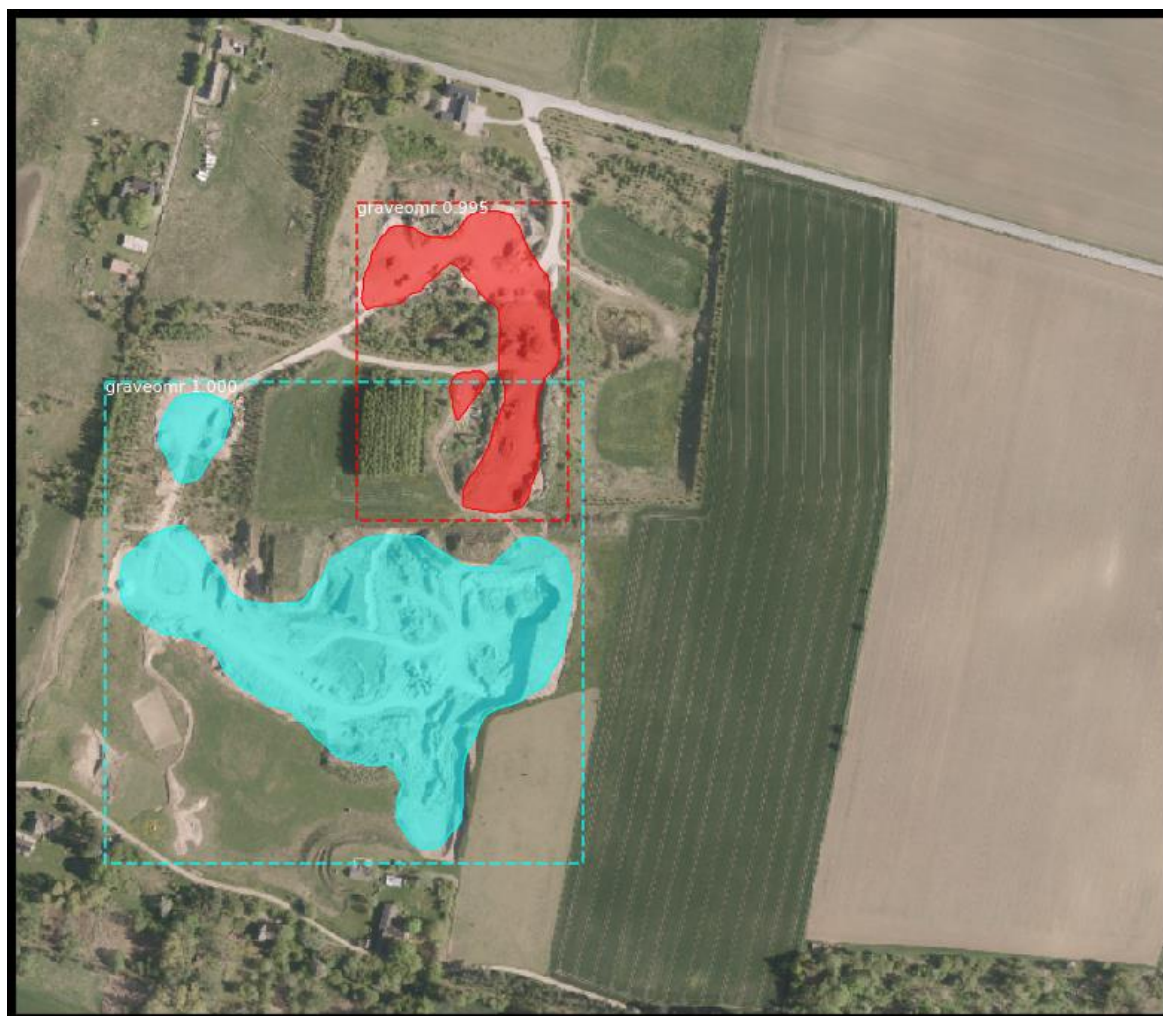
Fig. 1: Identifikation og afgrænsning af aktive graveområder i ortofoto vha. af Mask R-CNN algoritmen
