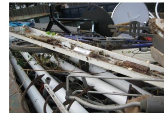
Lysstofarmatur med kondensator i container med blandet metalaffald - kan give anledning af forurening af andet affald, jord og omgivelserne i det hele taget.
