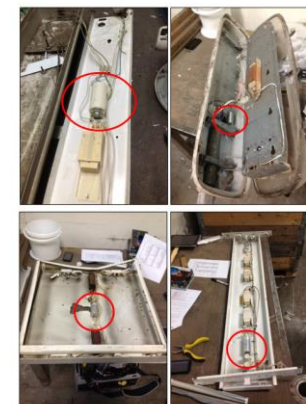
Lysstofarmatur med kondensator i container med blandet metalaffald - kan give anledning af forurening af andet affald, jord og omgivelserne i det hele taget.
